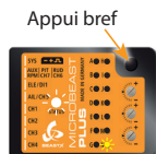
LED Status montre le mode actuel du Governor RPM
